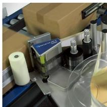
Keine Verteilung auf mehrere Produktionslinien erforderlich – der 9550 kann mit hohem Durchsatz Etiketten direkt drucken und aufbringen
