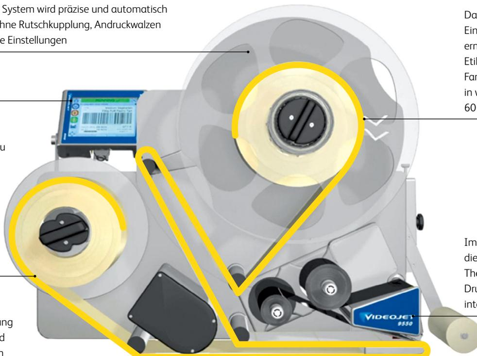
Das einfache Einlegeschema ermöglicht den Etiketten- und Farbbandtausch in weniger als 60 Sekunden
